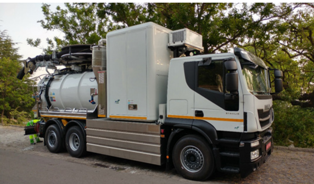
Equipo de alcantarillado de aspiración 100% eléctrico, Barcelona.
